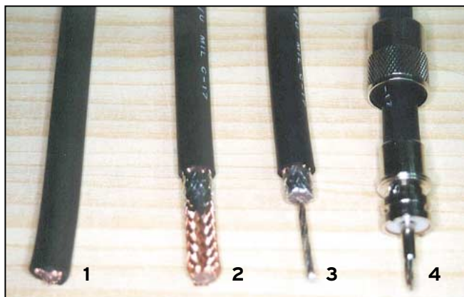
Figure 3 - Montage d'un connecteur PL-259.
